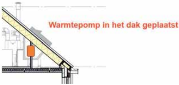
FIGUUR 3: WARMTEPOMP IN HET DAK GEPLAATST
